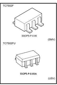
Weight SSOP5-P-0.95 : 0.016 g (typ.) SSOP5-P-0.65A
