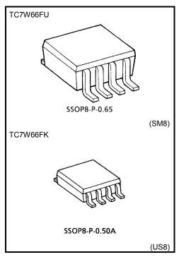
Weight SSOP8-P-0.65: 0.02 g (typ.) SSOP8-P-0.50A: 0.01 g (typ.)
