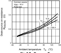
Fig. 8.7 R<sub>DS(ON)</sub> - T<sub>a</sub>
