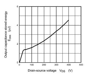
Fig. 8.10 E<sub>OSS</sub> - V<sub>DS</sub>
