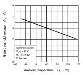
Fig. 8.11 V<sub>th</sub> - T<sub>a</sub>
