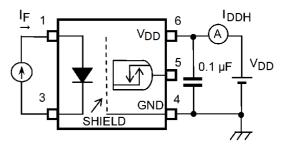
Fig. 12.4 IDDH Test Circuit
