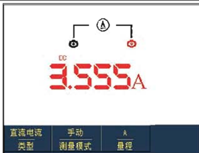
图5-9 大于400mA直流电流测量
