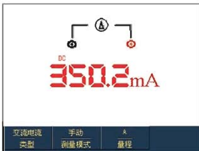
图5-15 测量40mA-400mA的直流电流
