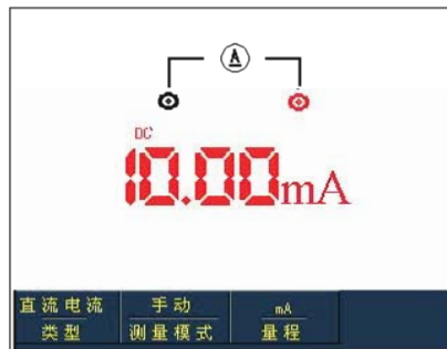
图5-14 小于40mA直流电流测量
