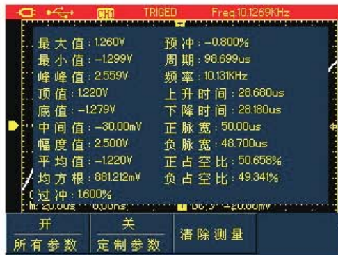
图4-17A UTD1000CL全部参数测量
