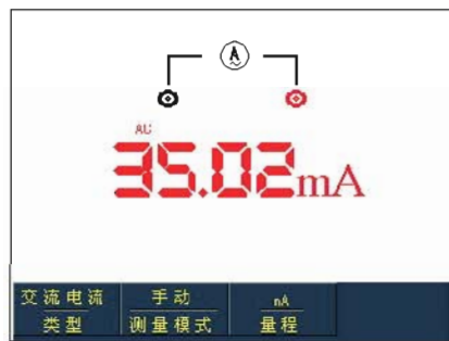
图5-11 小于400mA交流电流测量
