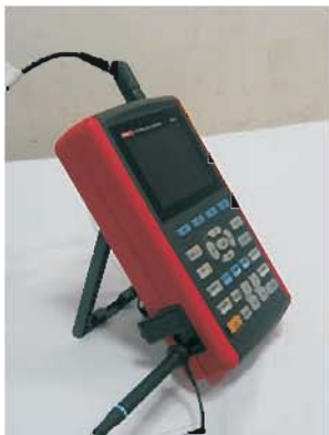
图3-2 本机补偿信号连接
