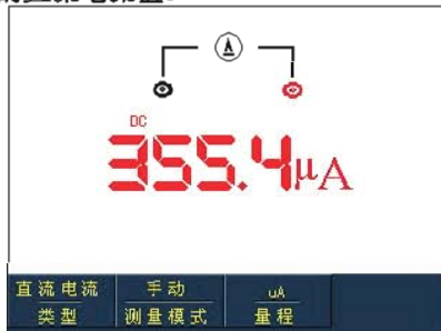
图5-13 小于等于1mA直流电流测量
