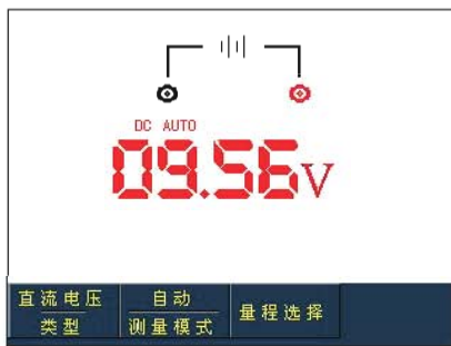
图5-5 直流电压测量
