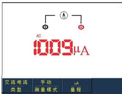
图5-17 小于等于1mA交流电流测量
