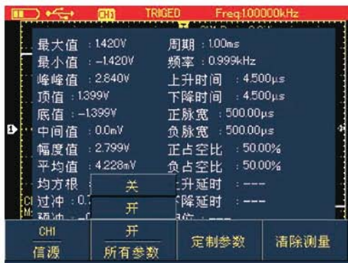
图4-17B UTD1000DL全部参数测量
