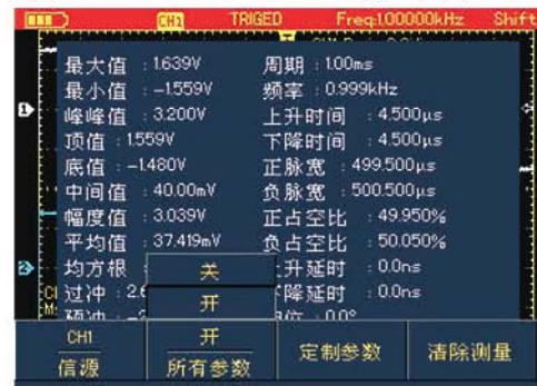
图6-16B UTD1000DL全部参数测量
