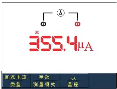
图5-7 小于4mA直流电流测量
