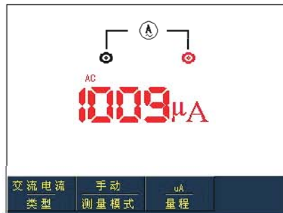
图5-10 小于4mA交流电流测量
