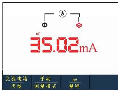
图5-18 小于40mA交流电流测量
