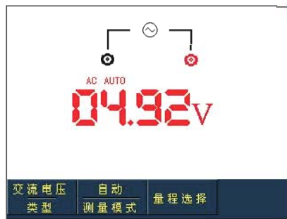
图5-6 交流电压测量
