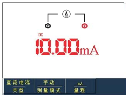
图5-8 小于400mA直流电流测量
