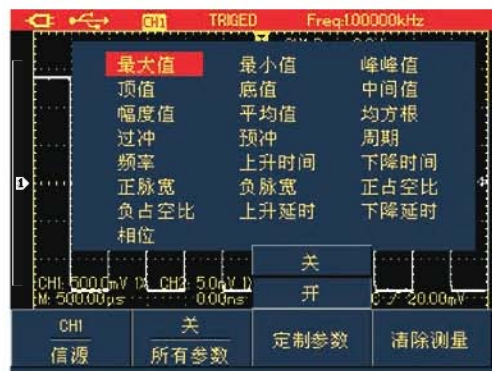
图4-18B UTD1000DL定制参数测量
