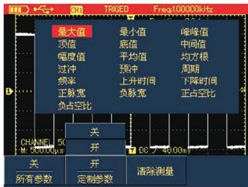
图4-18A UTD1000CL定制参数测量
