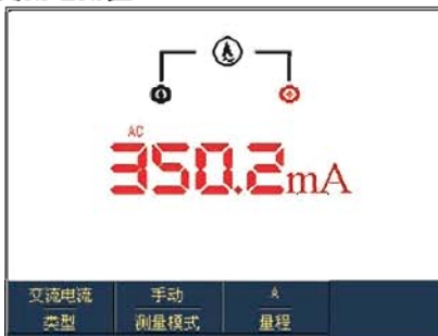
图5-19 测量40mA-400mA的交流流电流
