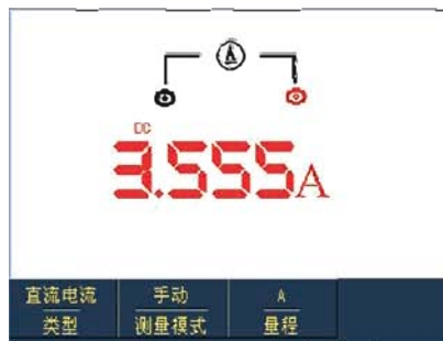
图5-16 大于400mA直流电流测量
