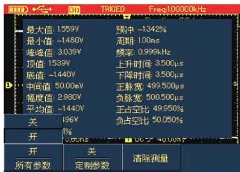
图6-16A UTD1000CL全部参数测量
