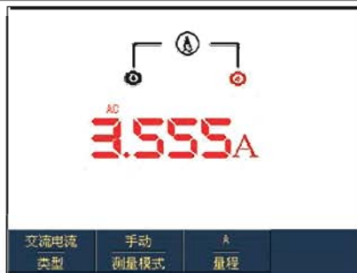
图5-20大于400mA交流电流测量
