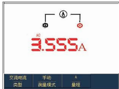
图5-12大于400mA交流电流测量
