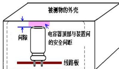
7.3、Do not place any wires or copper traces over the vent of the capacitor. 请不要在电容器的防爆阀上方放置任何电线或铜丝。
