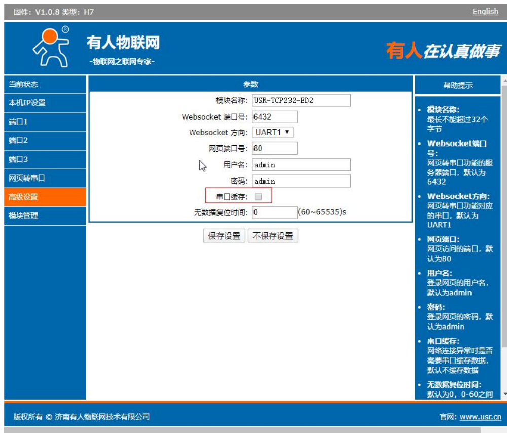
图 63 串口缓存数据设置图示
