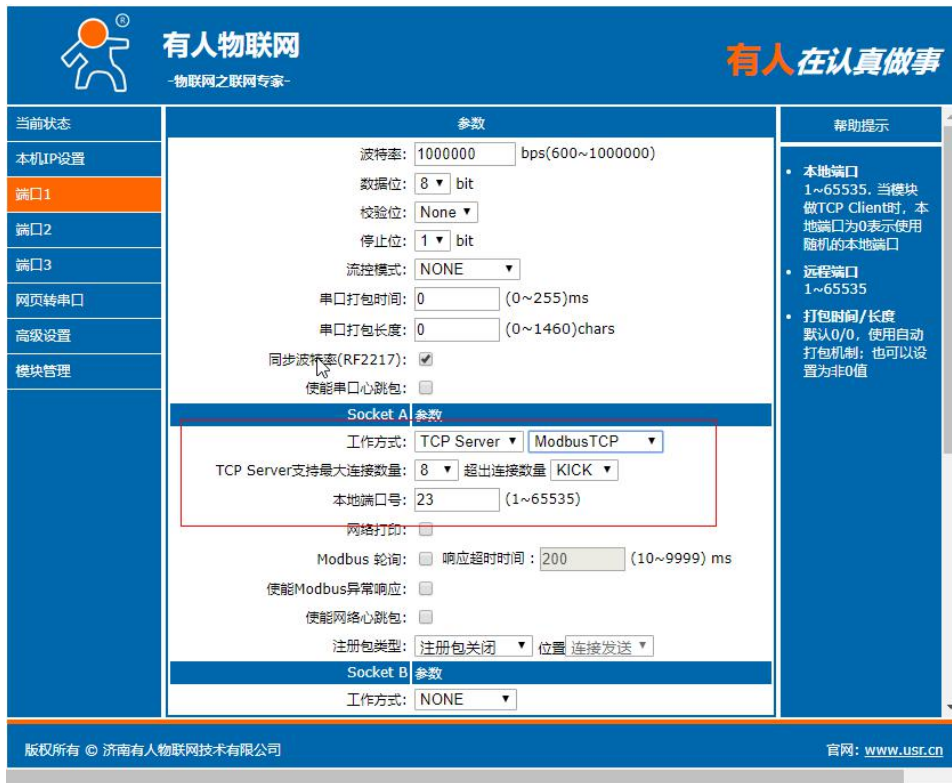
图 40 Modbus RTU 转 Modbus TCP
