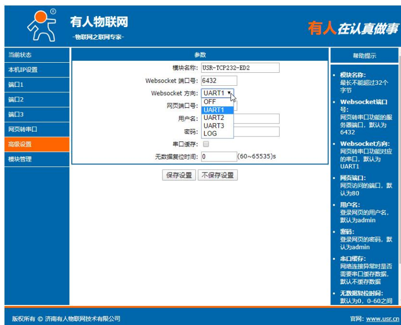
图 27 Websocket 方向设置
