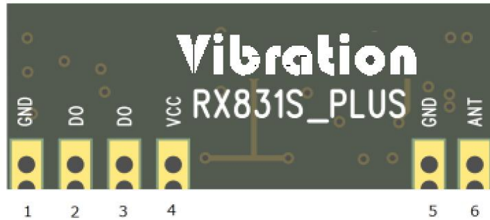
图 1 RX831_PLUS 管脚示意图
