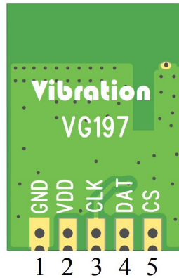
图 1 VG197M 管脚示意图
