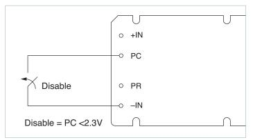
Figure 2 — Module enable/disable
