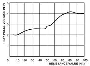
PEAK PULSE VOLTAGE LIMIT FOR AC03-CS
