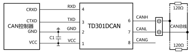
图 2. CAN 控制器 3.3V 供电应用电路
