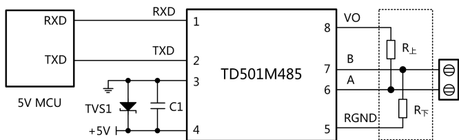
图 1.MCU 5V 供电应用电路
