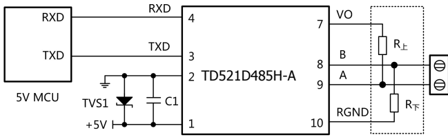
图 1.MCU 5V 供电应用电路
