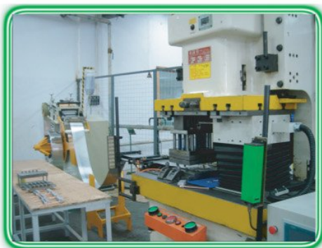
Heat Pipe & Stamping Fin Process 熱管組合鳍片
