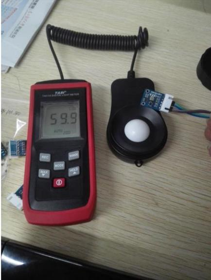
左图为传感器测出的通过串口打印的光照强度数值；
