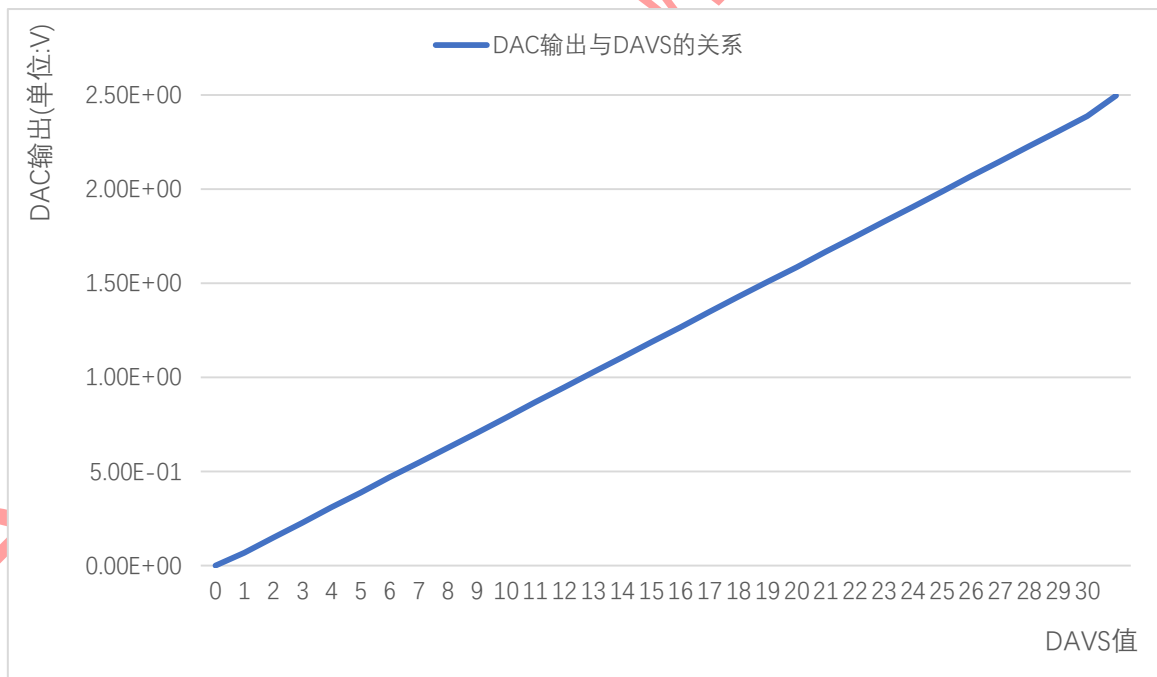
基准电压为外部 DAVF(2.5V)时 DAC 输出曲线
