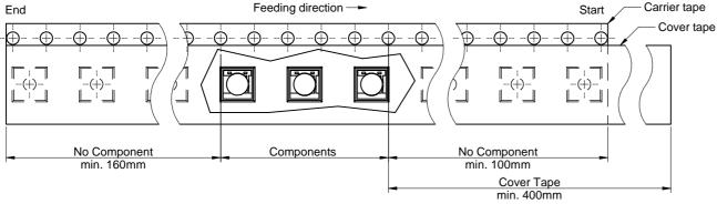
tolerance ± 2,0 min. min. min. + 2 max. min. max. Tape width 12 mm 178.00 1.50 12.80 20.20 50.00 12.40 18.40 11.90 15.40
