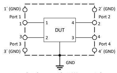
Network Analyzer: Keysight E5080A or equivalent
