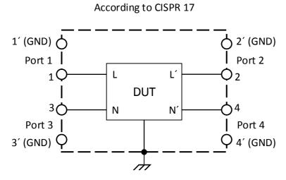
Network Analyzer: Keysight E5080A or equivalent
