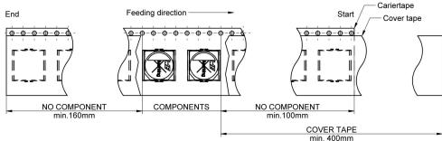
NO COMPONENT COMPONENTS NO COMPONENT min. 100mm
