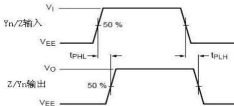
图 10、输入到输出传输延时(Z 到 Y<sub>n</sub> 或 Y<sub>n</sub> 到 Z) 和输出传输时间
