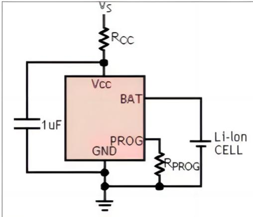
虽然这种应用可以在热调整模式中向 电池输送更多的能量并缩短充电时间，但在电压模式中，如果 VCC变得足够低而使 TP4056 处于低压降状态，则它实际上有可能延长充电时间。图 4 示出了该电路是如何随着RCC 的变大而导致电压下降
