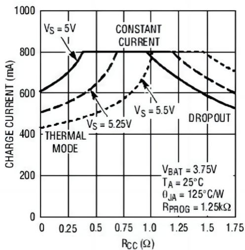
图 4：充电电流与  $R_{CC}$  的关系曲线
