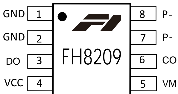
图 1 FH8209 管脚排列图（不成比例）
