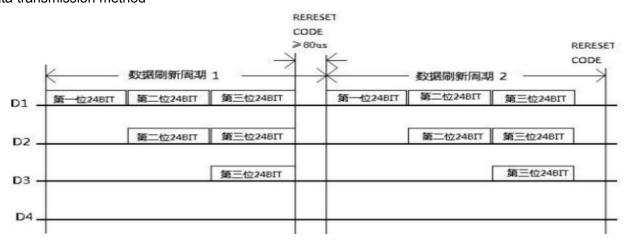
注: 其中 D1 为 MCU 端发送的数据, D2、D3、D4 为级联电路自动整形转发的数据。
