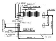
RECOMMENDED PCB LAYOUT (THICKNESS=1.6±0.15mm)
