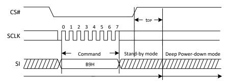
Figure 24. Deep Power-Down Sequence Diagram
