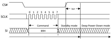
Figure 29. Deep Power-Down Sequence Diagram
