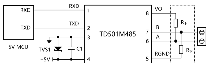
图 1.MCU 5V 供电应用电路
