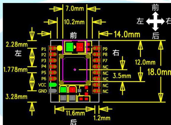
图 7 模组 PCB 封装尺寸
