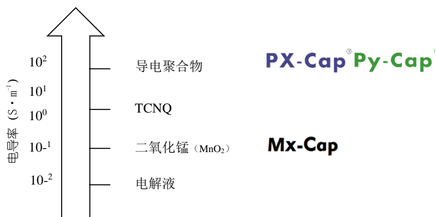
图 2. 典型电容器电解质电导率图
