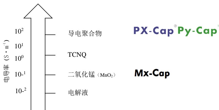
图 2. 典型电容器电解质电导率图
