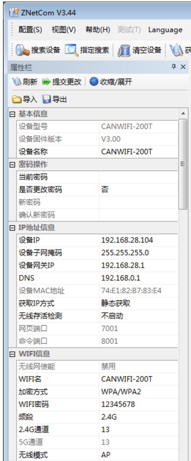
图 6.9 修改 CANWiFi-200T 设备配置
