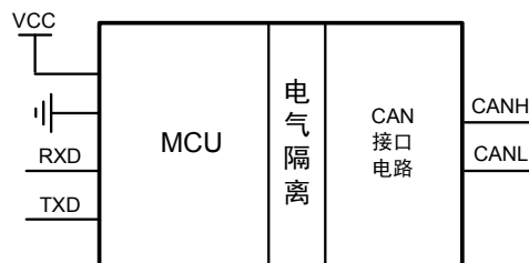
图 1 CSM100 系列模块的功能框图
