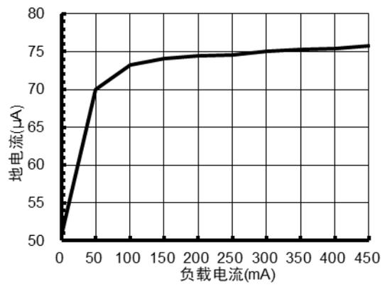
图 2.5 负载电流与地电流关系
