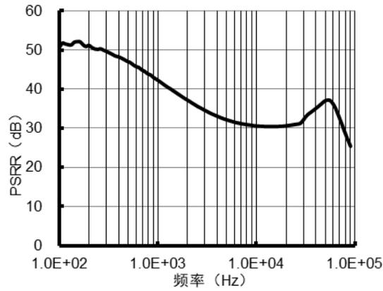
图 2.8 PSRR 与频率关系 ( $I_{OUT}=1mA$ )
