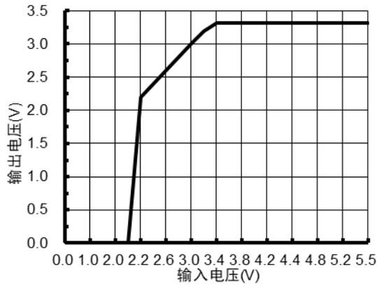
图 2.2 输入电压与输出电压关系
