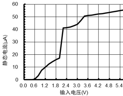
图 2.4 输入电压与静态电流关系
