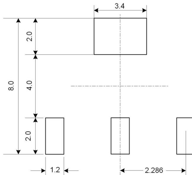
图 5.2 建议 PCB 封装尺寸
