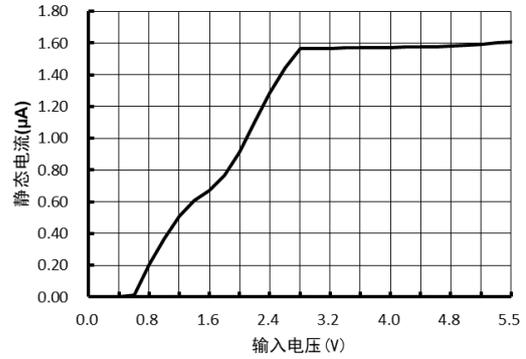
图 2.3 静态电流与输入电压关系 ( $I_{OUT}=0mA$ )
