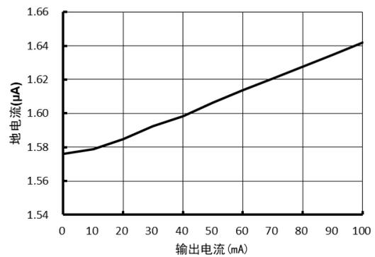
图 2.7 地电流与负载电流的关系
