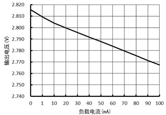
图 2.5 负载调整特性 ( $V_{IN}=4.8V$ )
