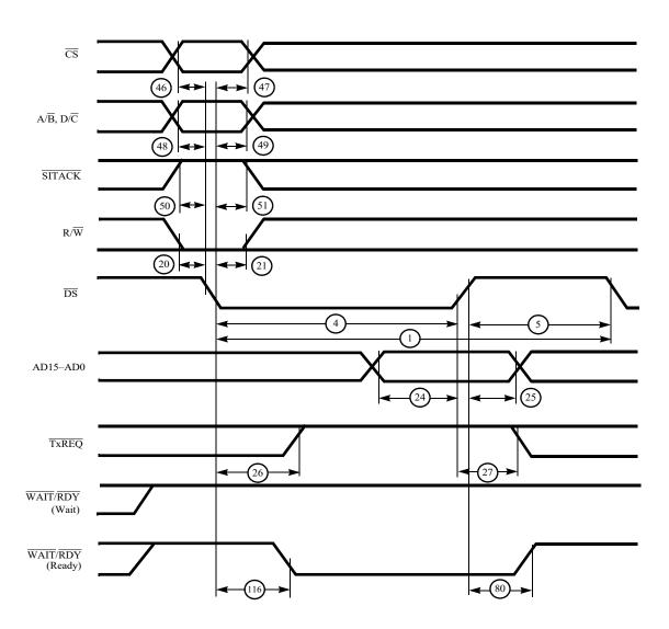
Figure 15. Nonmultiplexed  $\overline{\rm DS}$  Write Cycle
