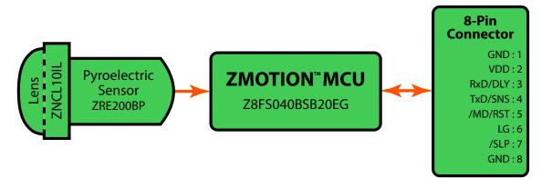
Figure 1. ZDMII Block Diagram (ZEPIR0BxS02MODG)
